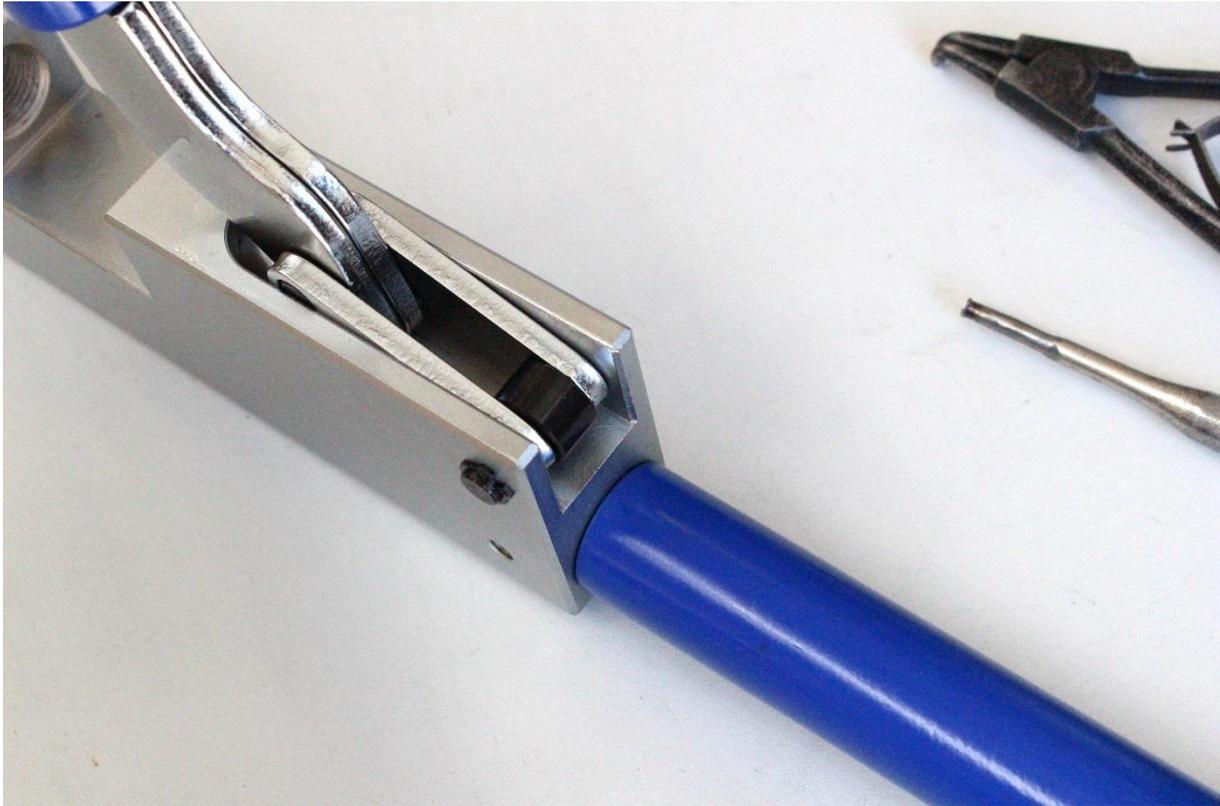
Montieren Sie den Handgriff mit Führungen und Gesenkaufnahme am Grundkörper und fixieren Sie den Bolzen.
