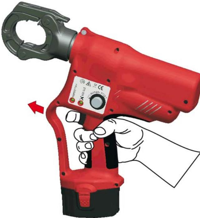
**Der Pressvorgang** wird nach Betätigung des schwarzen Schalters am Handgriff automatisch ausgeführt.
